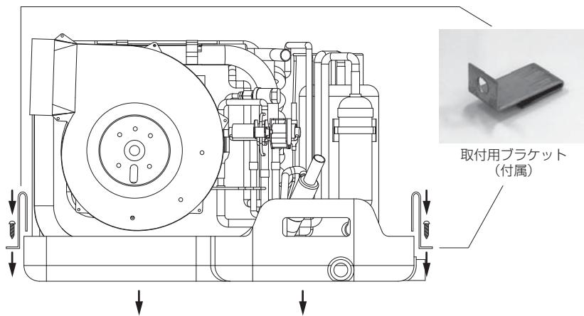
付属の滑り止めテープをエアコン底面に貼り付けた後に付属のブラケットをエアコン下部の縁に取り付けてから床面に木ネジなどを使用してしっかりと取り付けて固定してください。ブラケットは 4 個付属しています。(床面取付用の木ネジは付属しておりませんのでご注意ください)
