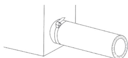
3. 折り返した切断面を戻して、ホースクランプなどで締め付けしてください。
