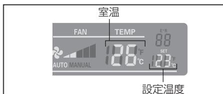
液晶ディスプレイの SET 下部の数字は設定温度の表示で、コントロールパネルの温度設定ボタンを押して設定温度を調整します。
