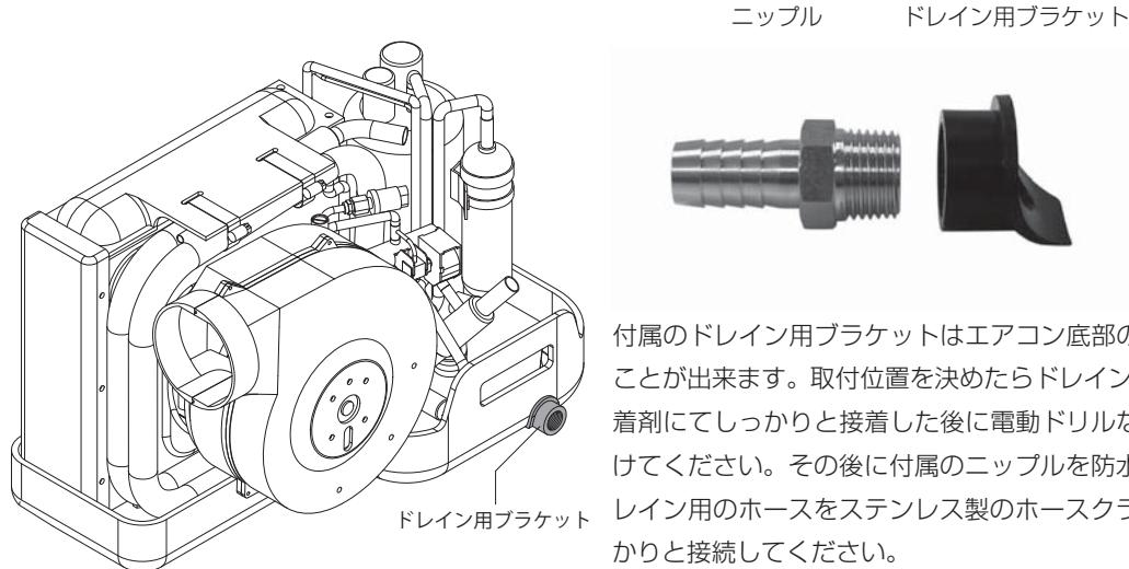
付属のドレイン用ブラケットはエアコン底部の好きな位置に取り付けることが出来ます。取付位置を決めたらドレイン用ブラケットを ABS 用接着剤にてしっかりと接着した後に電動ドリルなどでドレイン用の穴を開けてください。その後に付属のニップルを防水加工と共に取り付けてドレイン用のホースをステンレス製のホースクランプを 2 個使用してしっかりと接続してください。
