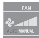
AUTO の文字が点灯し、室温と設定状態によって自動で風量を調整します。
