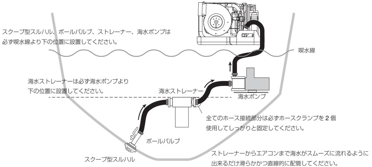
□ 配管に使用する部品は適切な物、もしくはオプションの配管キットを使用するようにしてください。
