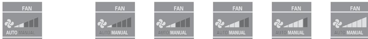
AUTOの文字が点灯し、室温と設定状態によって自動で風量を調整します。
