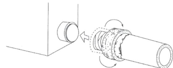
2. ダクト内側部をフランジに押し込み、粘着テープでしっかりと巻き付け、固定します。この時エア漏れのないようにしてください。
