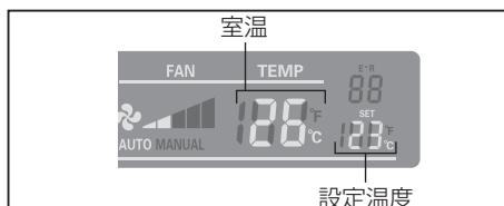
液晶ディスプレイの SET 下部の数字は設定温度の表示で、コントロールパネルの温度設定ボタンを押して設定温度を調整します。
