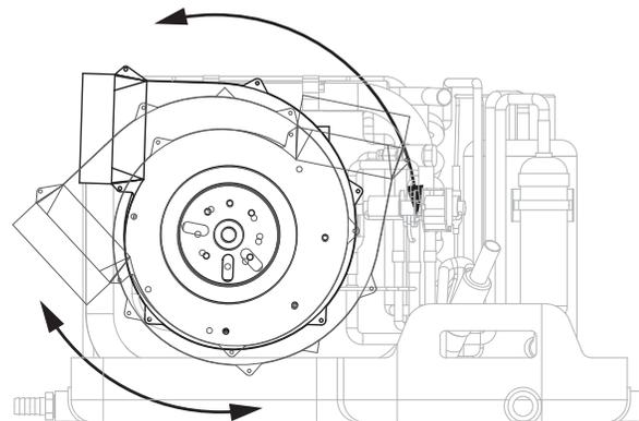
エアコン吹き出し口の横にある吹き出し口固定ネジを緩めると吹き出し口を無段階に調整できます。吹き出し口を最適な位置に調整して固定ネジをしっかりと締め直して固定してください。
