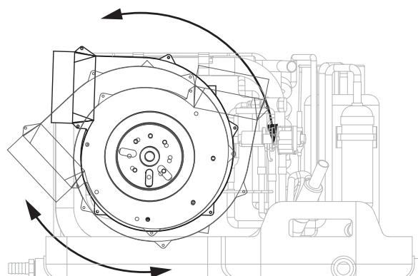
エアコン吹き出し口の横にある吹き出し口固定ネジを緩めると吹き出し口を無段階に調整できます。
