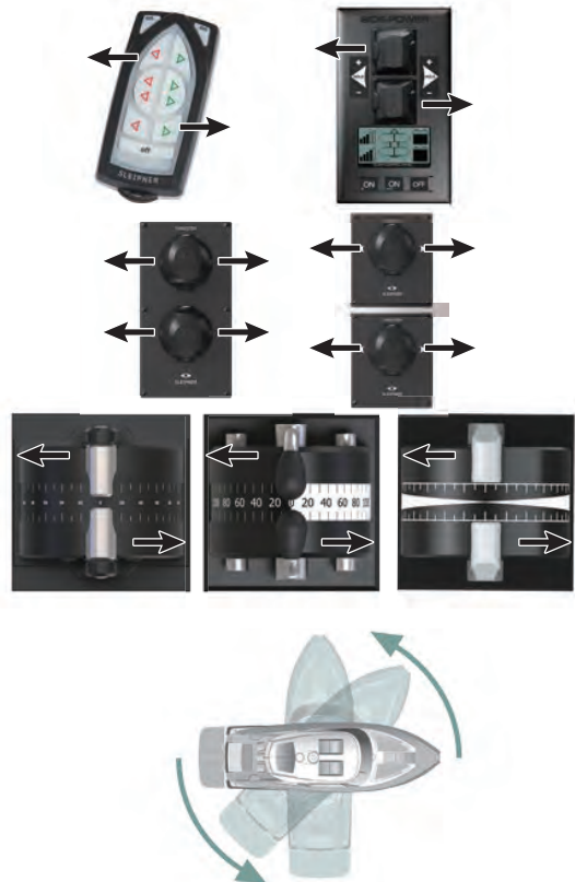
パウ & スターンスラスタ同時作動によるその場での回転
