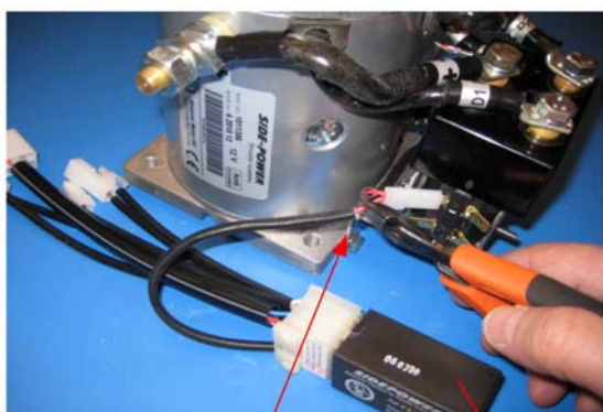
写真1 赤配線カット部分 コントロールボックス
