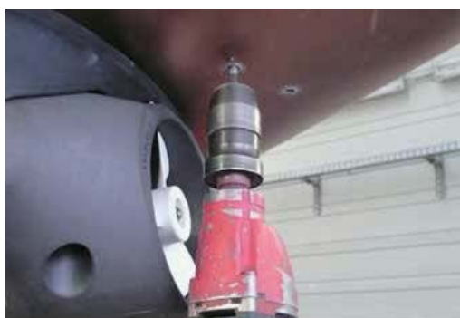
図 14：取付用ボルトキットのために穴を開ける
