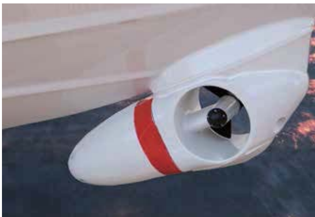
図 31. 取付、表面処理をおこなった EX スラスター
