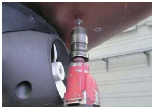
図 24：取付用ボルトキットのために穴を開ける
